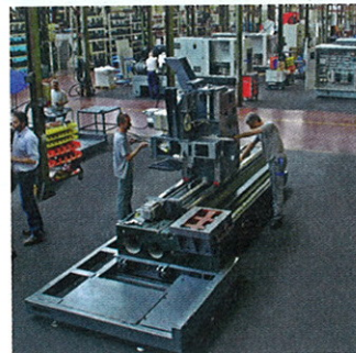
Machine multifonction bibranche type Genymab en cours de montage.
