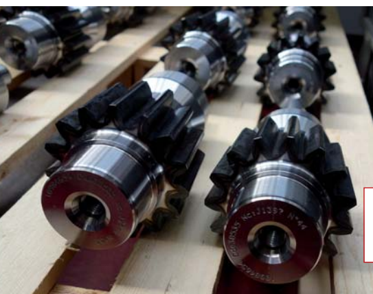
Chez Chandieux une palette d'engrenages après traitement thermique de la denture par induction
