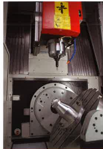
Le travail en 5 axes sur 5 faces permet de finir complètement en un seul serrage des pièces complexes et de formes. Avec le centre DIAM 620, le rapport prix-performance-qualité est au rendez-vous, service SOMAB en plus.
