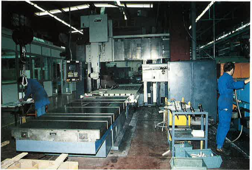
Fig. 7 — Cette grosse fraiseuse à portique Liné fait partie des investissements récents. Elle sert, en partie, à répondre à une activité de sous-traitance haut de gamme.
