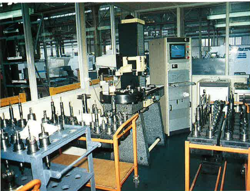
Fig. 16 — Une machine de pré-réglage des outils permet d'en mémoriser les cotes au moment de leur préparation, cotes qui sont, ensuite, rappelées avec les programmes pièces.
