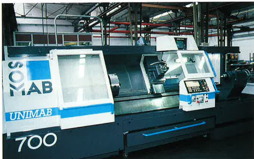
Fig. 20 — Récente extension du programme Unimab, ce modèle 700 admettant jusqu'à 3 m entre pointes.
