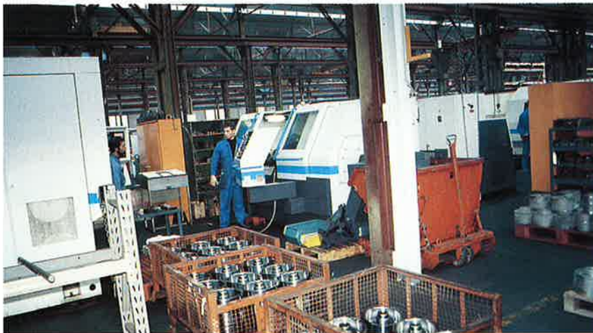
Fig. 10 — Partie des ateliers de tournage où sont essentiellement utilisés, cela s'impose, des tours Somab.
