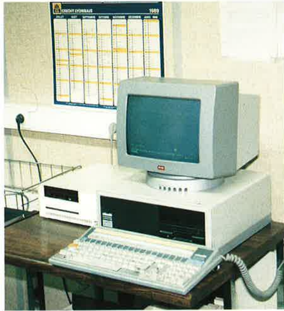
Fig. 17 — Cet ordinateur qui, la plupart du temps, tourne seul, envoie les programmes directement à seize des machines à CNC dans les ateliers.
