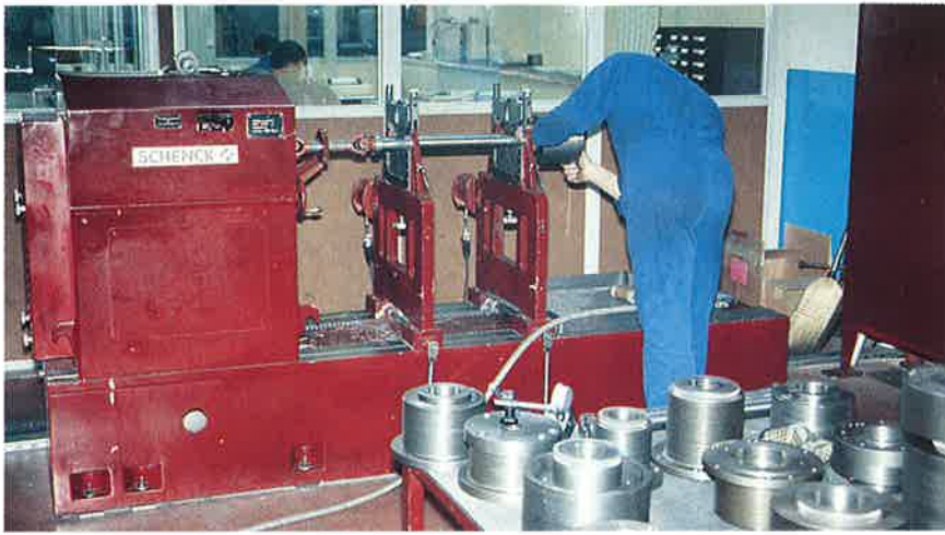
Fig. 12 — Opération d'équilibrage des broches après leur assemblage, destinée à éviter tous risques de vibrations à l'usage.
