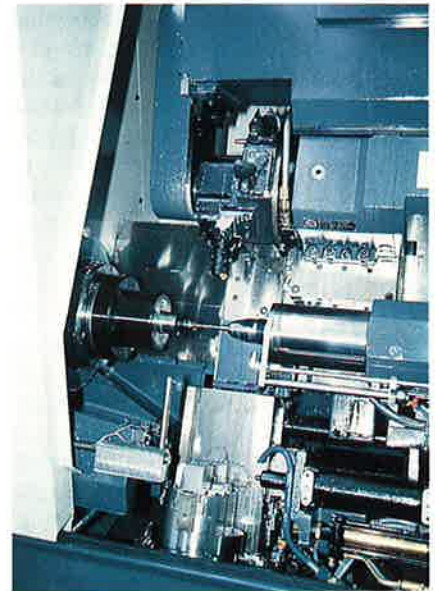
Fig. 25 — (A gauche) Un intéressant développement, dérivé d'un tour Transmab, consiste en une machine spéciale pour l'usinage de tous les types d'éprouvettes.
