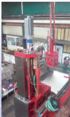
Reconditionnement mécanique et électrique d'un tour vertical .
