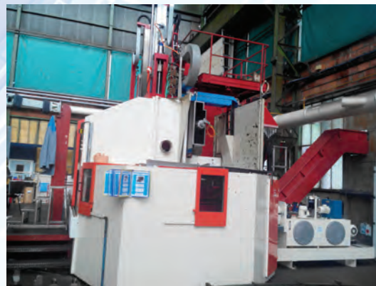
Reconditionnement mécanique et électrique d'un tour vertical .
