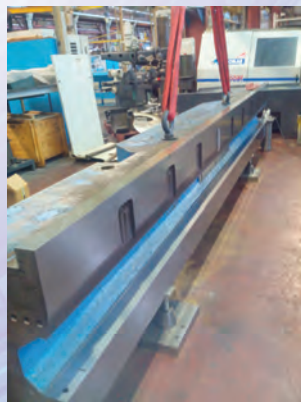
Reconditionnement mécanique et électrique d'un tour vertical .
