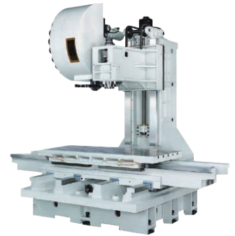
Guidage prismatique Prismatique sur les 3 axes
